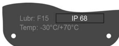
Obr. 25: Příklad: Typový štítek s krytím IP68
