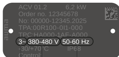
Obr. 23: Příklad typového štítku ovládací jednotky servopohonu
